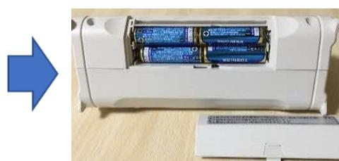
④底面のふたを開け付属の乾電池を4本入れます。電池を交換する際はアルカリ電池を推奨しています。
