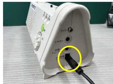
③戸別受信機の向かって右側面の外部電源端子にアダプタコードを接続します。
