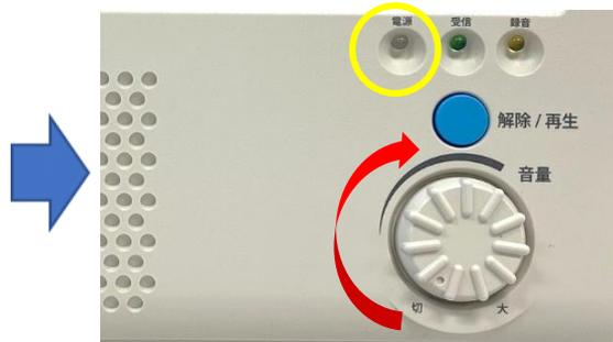
⑤ダイヤルを右に回すと電源が入ります。ダイヤルを回して音量を調節してください。
