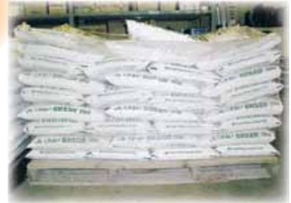
生石灰は水分と反応して熱を発生させる性質があります。
