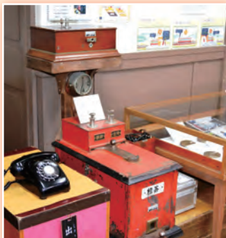
中央の赤い機械が通票閉塞器
